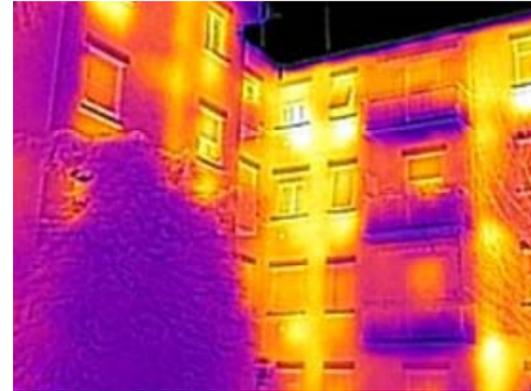
**La posa di un “cappotto termico” riduce le perdite del sistema di distribuzione del calore che, seppur non evidenti, sono presenti in tutti gli impianti!**
